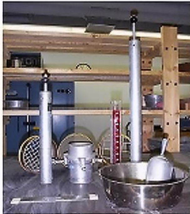
Fig 1.1 T 99/T 180 Test Apparatus
