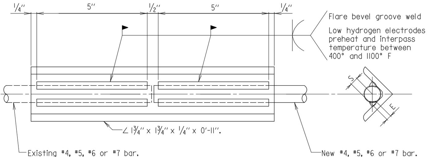
Flare bevel groove weld
